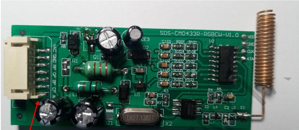
1. VAC：电源输入，接整流桥正极
